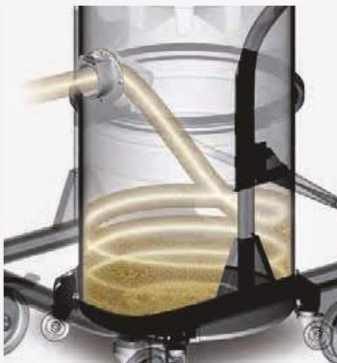
Универсальный пылесос, подходящий для сбора любого материала, будь то жидкие или сухие вещества, оснащён центральным впуском, который, благодаря наличию дефлектора, направляет поток жидкости вниз, чтобы избежать намочания фильтра. Что касается всасывания пыли, то эта система является менее эффективной, чем тангенциальный впуск, так как дефлектор существенно замедляет поток порошкообразной субстанции, которая гораздо легче притягивается к фильтру.
