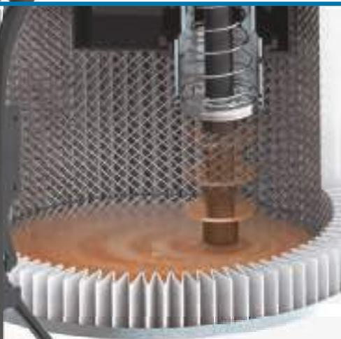
Модели ST являются одними из самых популярных среди данной серии, поскольку они предназначены для общего сбора пыли и твёрдых частиц, поэтому менее подходят для более специфичных задач. Данные машины комплектуются одно- или трёхфазными турбинами с боковым каналом, изготавливаемыми из литого алюминия. Чрезвычайно прочные, тихие, мощные, надёжные, они прекрасно подойдут для непрерывного использования 24 часа в сутки.
