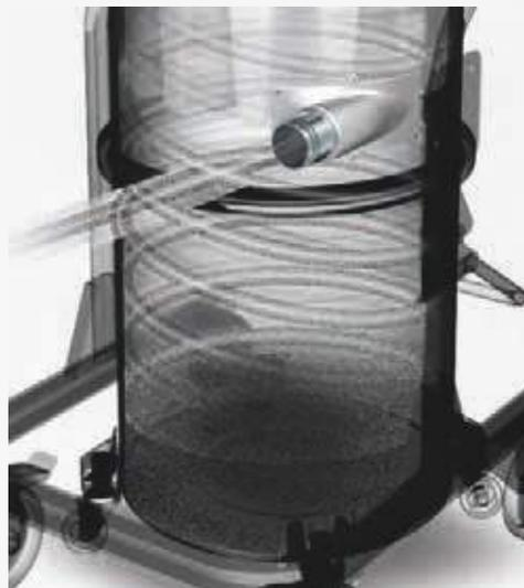
Наилучшую конструкцию для сбора пыли имеет тангенциальный тип впуска, поскольку скорость воздуха в контейнере выше, чем при применении прямого центрального впуска, что создаёт эффект циклона и способствует лучшему отделению пыли от фильтра.
